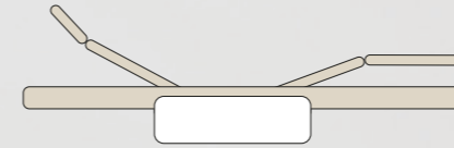
Andere motorische Lattenroste – die Motoreinheit ragt nach unten heraus
